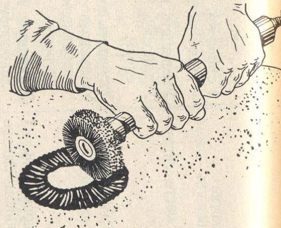
Рис. 31. Шероховка поврежденного места обкладки ленты.
