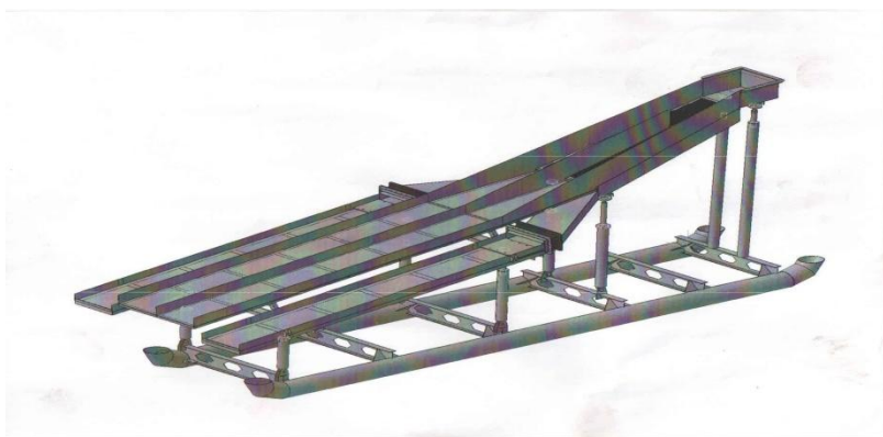
На рисунке изображен шлюзовой комплекс РПШК-30м 2
