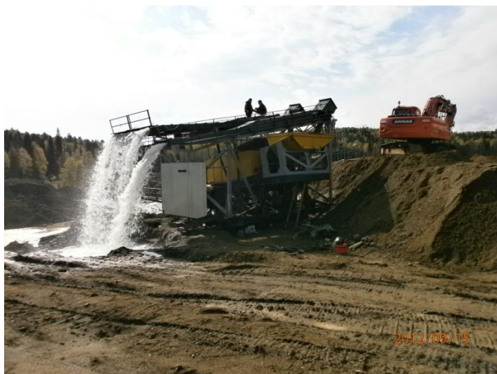
СПЗК-60 самоходный комплекс на базе скруббер-бутары 100 м 3 /ч показанной ниже
